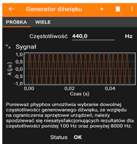
Rysunek 13. Widok wskazań zmiany wartości amplitudy w czasie, przy zadanej wartości częstotliwości generowanego dźwięku
