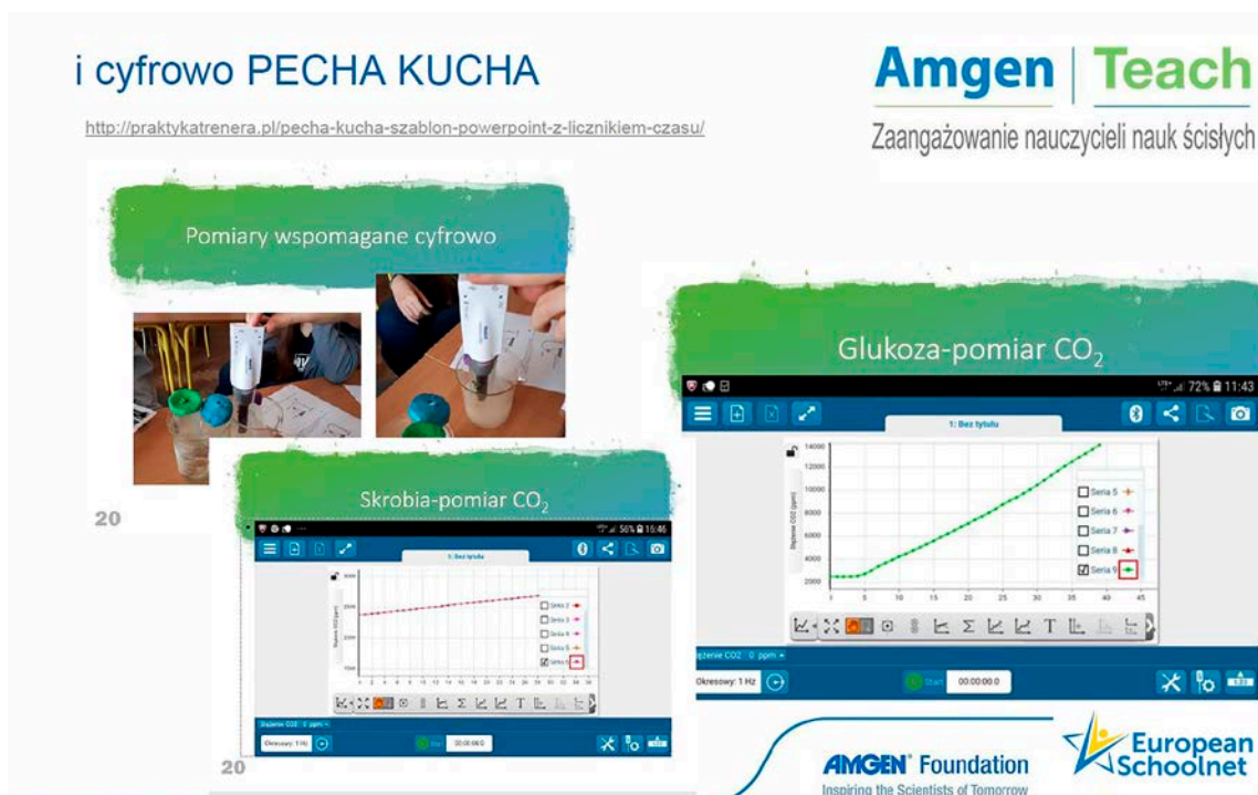
Rysunek 11. Wykresy liniowe obrazujące wydzielanie tlenu węgla (IV) w procesie fermentacji alkoholowej drożdży w zależności od rodzaju użytego cukru
